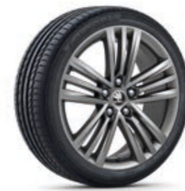
Trinity 3T0 071 498A HA7 Kolo z lehké slitiny 7,5J × 18" ET46 pro pneumatiky s rozměry 225/45 R18, v antracitové metalické barvě (pouze OCTAVIA SCOUT) ŠKODA Originální příslušenství
