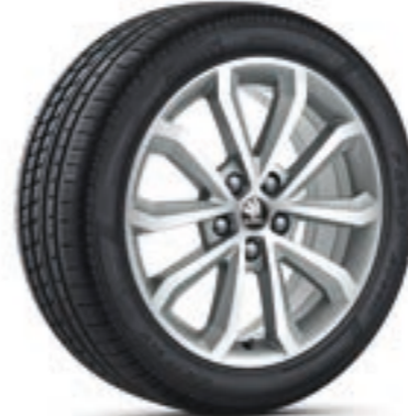
Hawk 5E0 071 497H 8Z8 Kolo z lehké slitiny 7J × 17" ET49 pro pneumatiky s rozměry 225/45 R17, ve stříbrné metalické barvě, broušené ŠKODA Originální příslušenství
