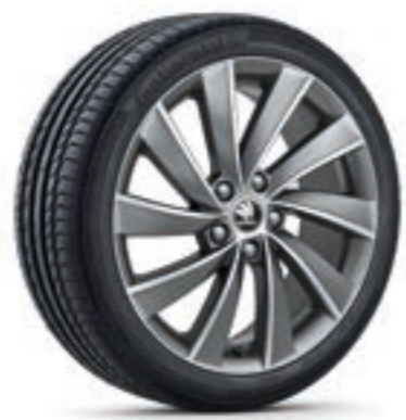
Turbine 5E0 071 498J HA7 Kolo z lehké slitiny 7,5J × 18" ET51 pro pneumatiky s rozměry 225/40 R18, v antracitové metalické barvě, broušené ŠKODA Originální příslušenství
