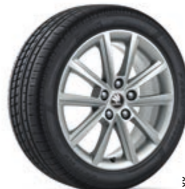
Teron 5E0 071 497A 8Z8 Kolo z lehké slitiny 7J × 17" ET49 pro pneumatiky s rozměry 225/45 R17, ve stříbrné metalické barvě ŠKODA Originální příslušenství
