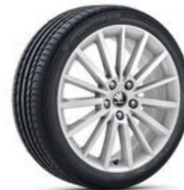
Turini 5E0 071 498A FM9 Kolo z lehké slitiny 7,5J × 18" ET51 pro pneumatiky s rozměry 225/40 R18, v bílé barvě ŠKODA Originální příslušenství
