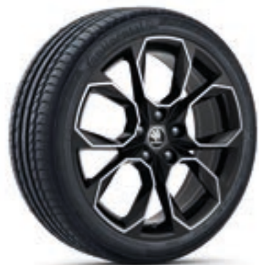
Xtrem 5E0 071 499A JX2 Kolo z lehké slitiny 7,5J × 19" ET51 pro pneumatiky s rozměry 225/35 R19, v černé lesklé barvě, broušené (pouze OCTAVIA RS) ŠKODA Originální příslušenství
