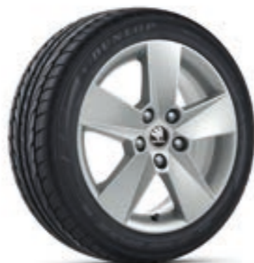
Ilias 5E0 071 496D 8Z8 Kolo z lehké slitiny 6,5J × 16" ET50 pro pneumatiky s rozměry 205/55 R16, ve stříbrné metalické barvě ŠKODA Originální příslušenství
