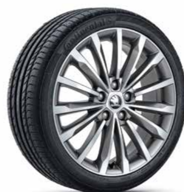
Trinity 57A 071 498A HA7 Kolo z lehké slitiny 7J × 18" ET45 pro pneumatiky s rozměry 215/50 R18 (4×2) a 225/50 R18 (4×4) v antracitové metalické barvě, broušené ŠKODA Originální příslušenství
