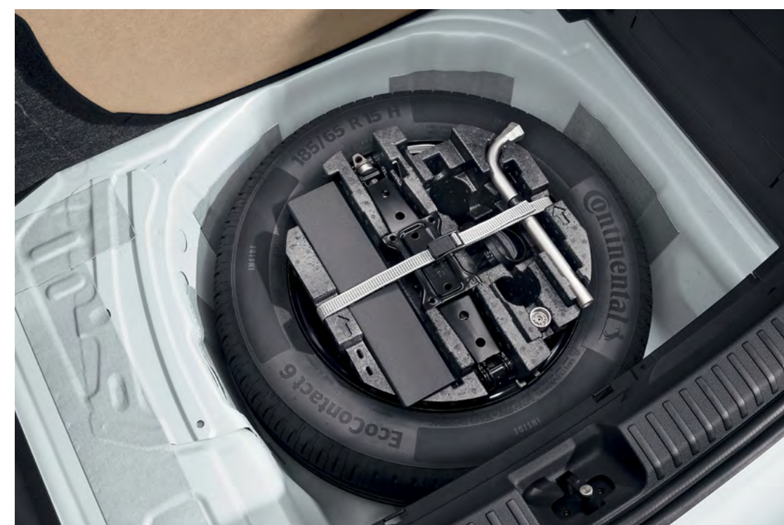
Rezervní kolo pro 15" kola (plnohodnotné)
