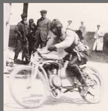
Václav Vondřich s brašnou na zádech (1905) na stroji bez převodovky, přední brzdy a s pohonem zadního kola řemenem.
