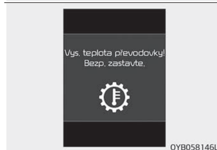
Vysoká teplota převodovky
