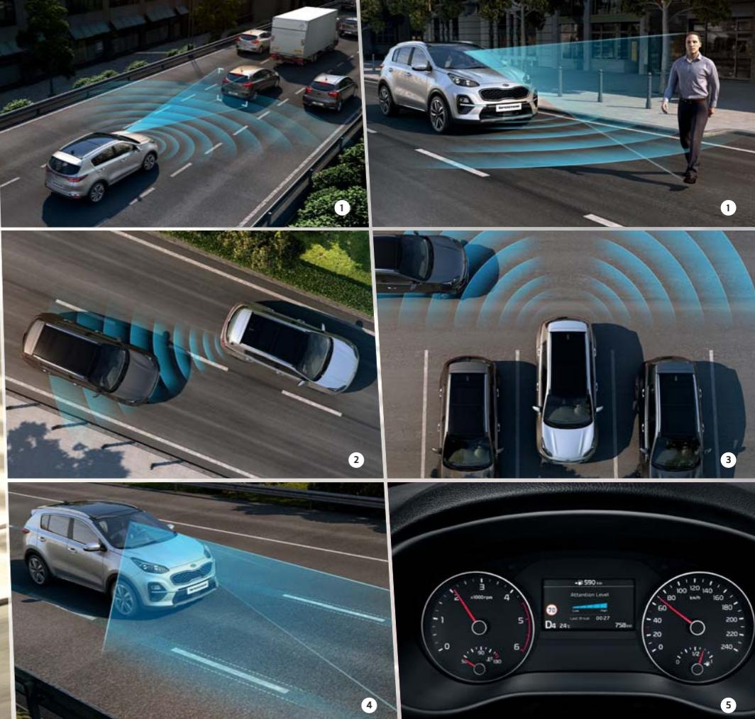
1. **Systém autonomního nouzového brzdění FCA** detekuje vpředu jedoucí vozidla a chodce přecházející silnici. Vzdálenost a rychlosť vozidel je určována pomocí senzorů a kamery. Řidič je upozorněn, pokud existuje riziko kolize. Jestliže řidič nereaguje, vůz automaticky brzdí, čímž může kolizi zabránit, nebo alespoň zmírnit intenzitu nárazu.
