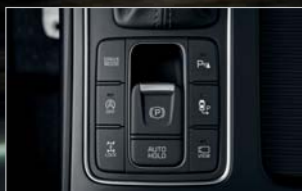
Volič jízdních režimů Pouhým stiskem tlačítka lze vybírat mezi režimy Normal, Eco a Sport měnícími strategii řazení samočinné převodovky podle jízdního stylu a provozních podmínek. Normal pro každodenní ježdění, Eco pro maximálně hospodárný provoz a Sport pro ještě dynamičtější svezení. Standard u verzí se samočinnou převodovkou.
