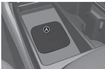
[A] Autentizační podložka ve vozidle (bezdrátová nabíjecí podložka)
