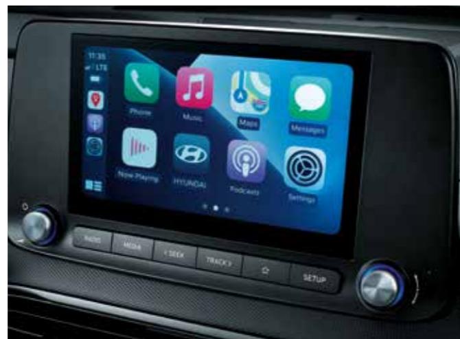
Audiosystém s displejem o velikosti 8" je vybaven funkcí bezdrátového zrcadlení displeje připojeného mobilního telefonu
